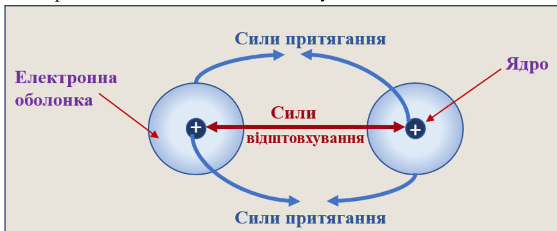
Рис. 1.7. баланс сил притягання та відштовхування під час утворення хімічного зв'язку.
