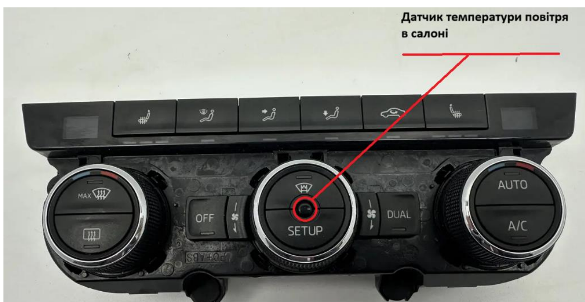
Рисунок 1.15 – Блок керування клімат-контролем та датчик температури в ньому Skoda Octavia A7
