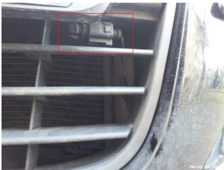
Рисунок 1.18 – Датчик температури навколишнього середовища VW Golf V, розміщений в решітці переднього бамперу
