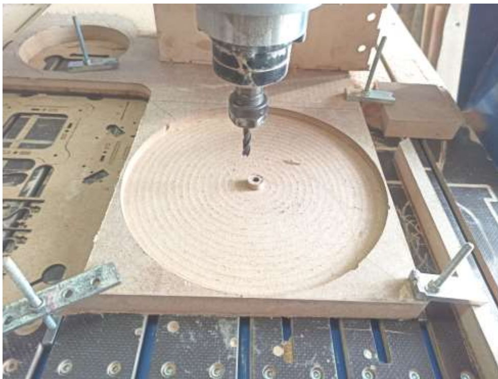
Рисунок 4.1 – Результат фрезерування першої половини деталі платформа
