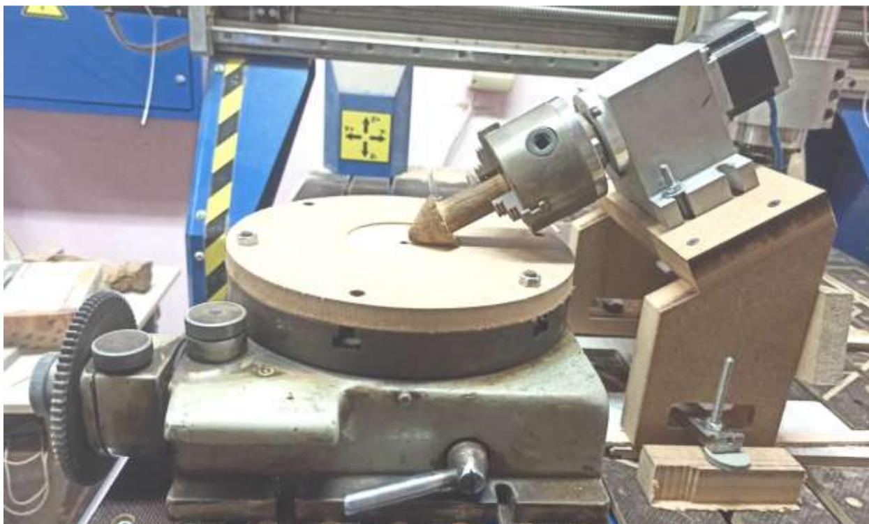
Рисунок 4.5 – Виготовлена оснастка (вид збоку)
