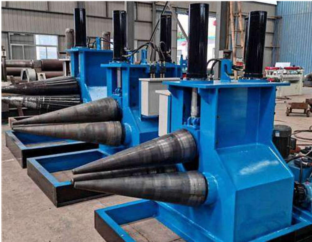
Рисунок 1.1 – Обладнання конусної прокатки металевих листів
