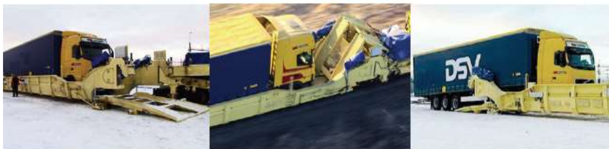
Рис. 1. Встановлення автомобіля на залізничну платформу по системі Flexiwaggon
