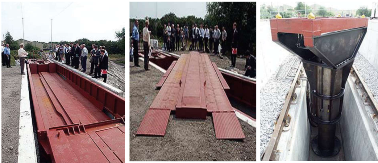
Рис. 4. Платформа і підйомний механізм системи CargoSpeed
