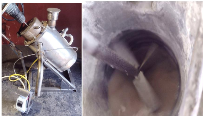
Рисунок 1. Реактор проведення реакцій розкладання ільменіту у розчині
