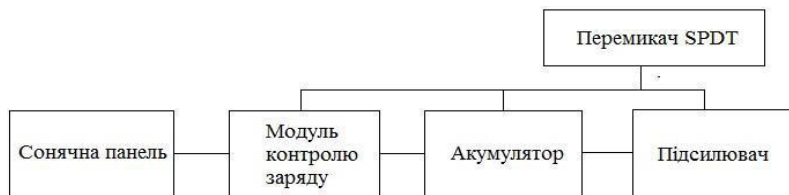
Рисунок 1. Блок-схема пристрою на сонячних панелях для заряду смартфона
