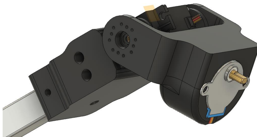
Рисунок 3.28 – Кріплення крокового двигуна «кисті» роботизованої руки
