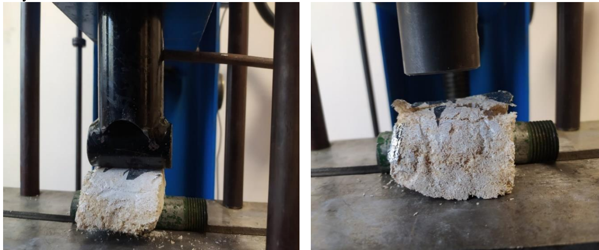
Рис. 2 – Дослідження на міцність теплоізоляційних виробів з деревини
