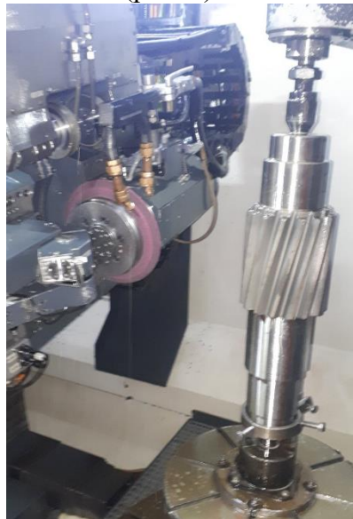
Рис. 1 – Установка шліфувального круга з рубін-корунду на верстаті
