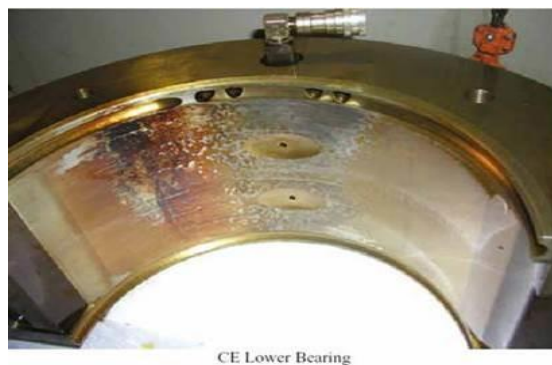
Рис. 1 – Пошкодження корпусу підшипника гідравлічного насосу
