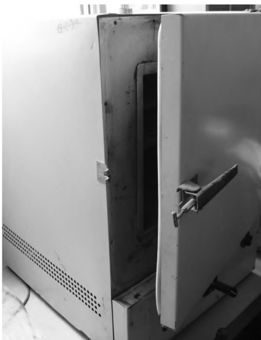
Рисунок 3.1 Обладнання, яке використовувалось у дослідженнях: сушильна електрошафа СНОЛ – 3,5.3,5.3,5/3 ИЗ; лабораторні ваги ТВЛ 0,5; ексикатор; щипці; бюкси
