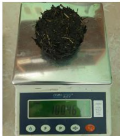
Фото процесу вимірювання висоти (а) та маси циліндра ущільненої суміші сапропелю із січкою соломи озимої пшениці
