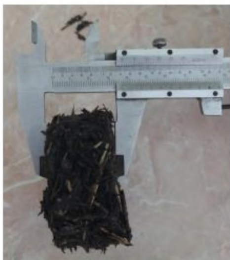
Фото процесу вимірювання висоти (а) та маси циліндра ущільненої суміші сапропелю із січкою соломи озимої пшениці
