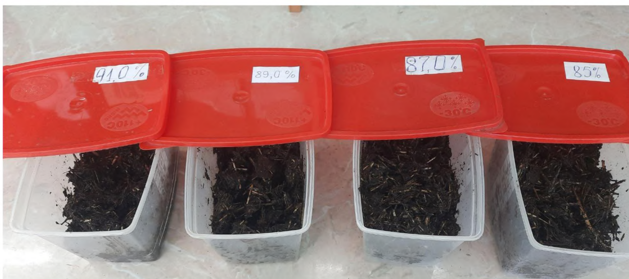
Рисунок 3.5 Фото досліджуваних зразків суміші сапропелю з січкою соломи озимої пшениці
