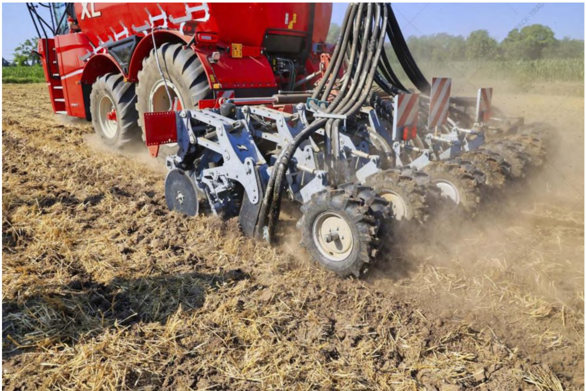
Рисунок 1.12 – Фото машини машини яка забезпечує внесення гноївки під час обробітку смуг за технологією Strip-till
