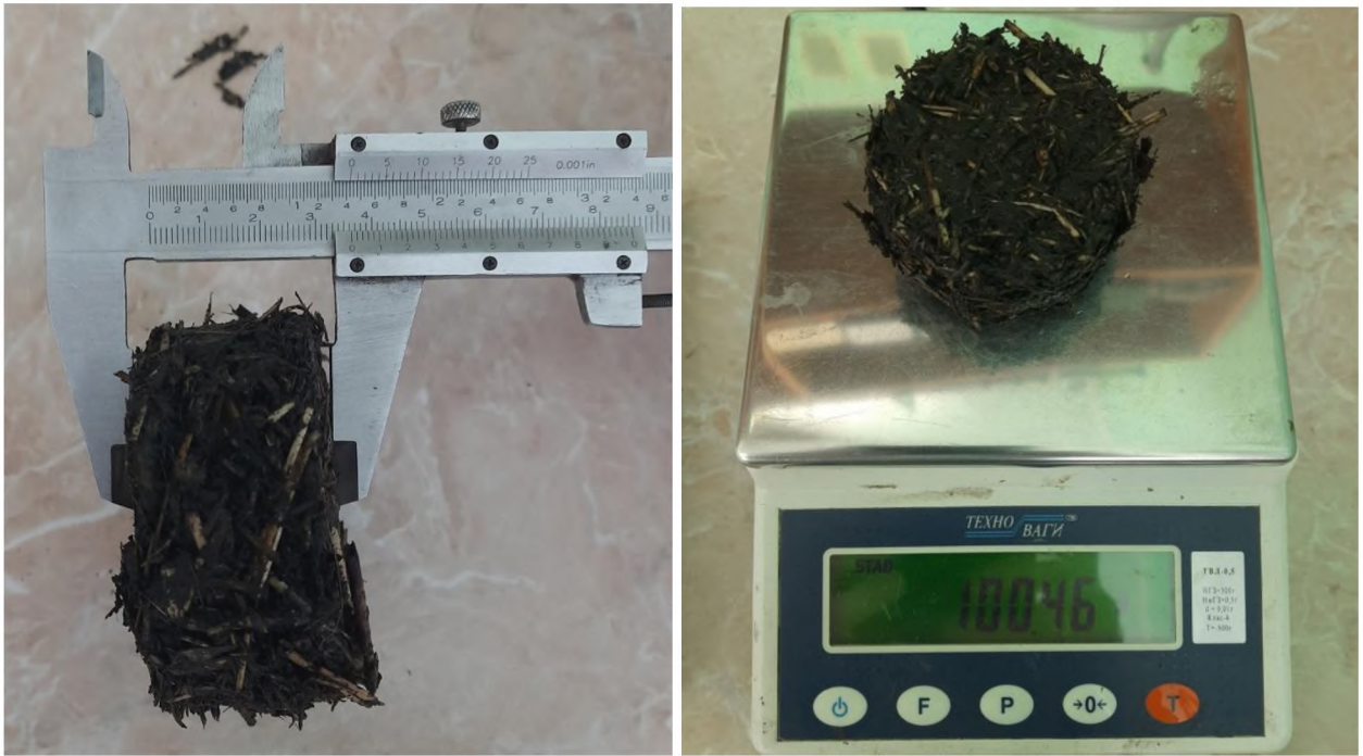
Рисунок 3.8 Фото процесу вимірювання висоти (а) та маси циліндра ущільненої суміші сапропелю із січкою соломи озимої пшениці
