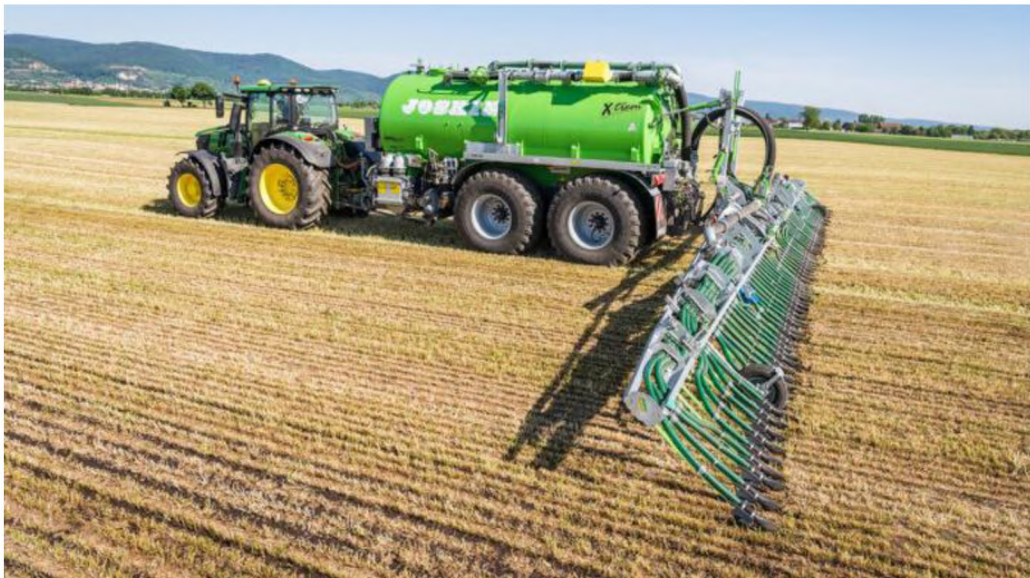
Рисунок 1.10 Фото машини для поверхневого внесення рідких органічних добрив
