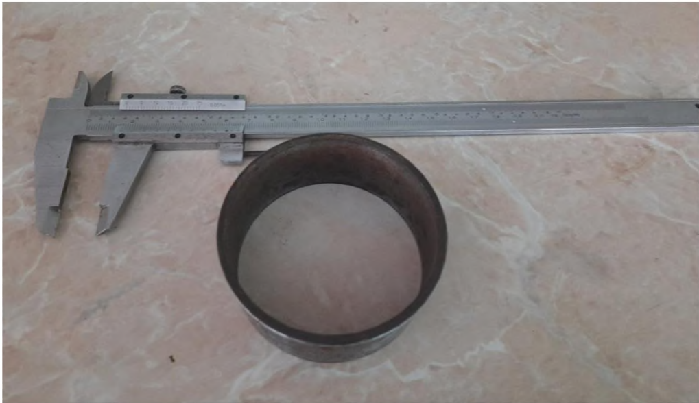
Рисунок 3.2 Обладнання для дослідження об'ємної маси суміші на основі сапропелю
