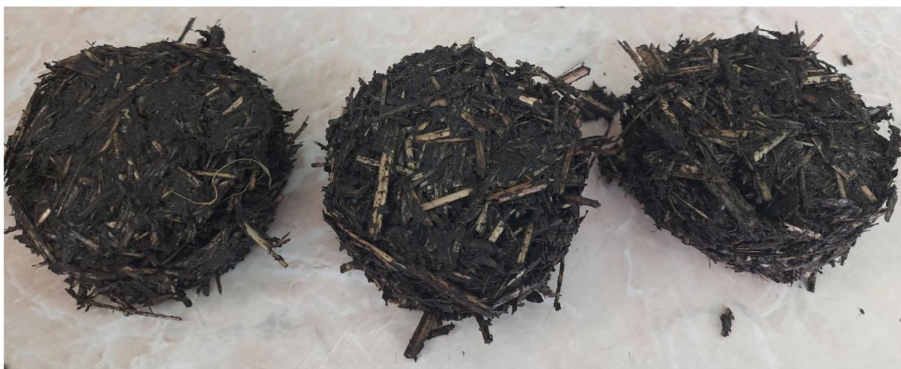
Рисунок 3.7 Зразки циліндрів ущільненої суміші сапропелю із січкою соломи озимої пшениці
