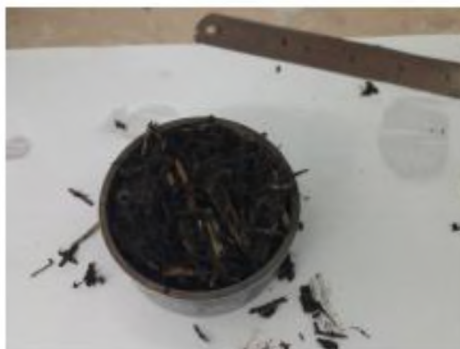
Фото ріжучого кільця із досліджуваною сумішшю
