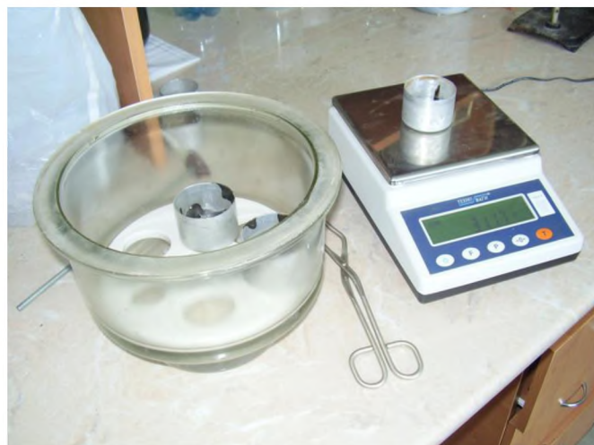
Рисунок 3.1 Обладнання, яке використовувалось у дослідженнях: сушильна електрошафа СНОЛ – 3,5.3,5.3,5/3 ИЗ; лабораторні ваги ТВЛ 0,5; ексикатор; щипці; бюкси
