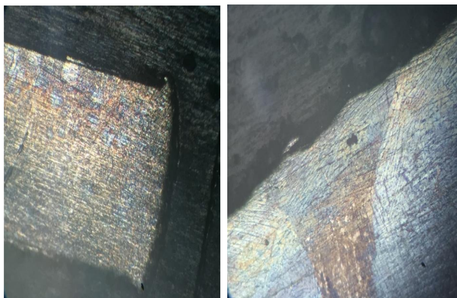
Рисунок 3. 4 Мікроструктури ОКП сплаву ВТ - 6 зразок №3:
