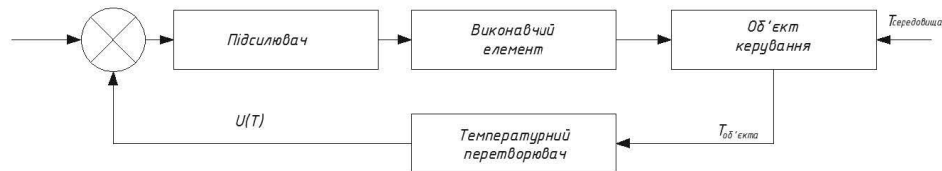
Рисунок 1 – Узагальнена схема термостатування зі зворотним зв'язком
