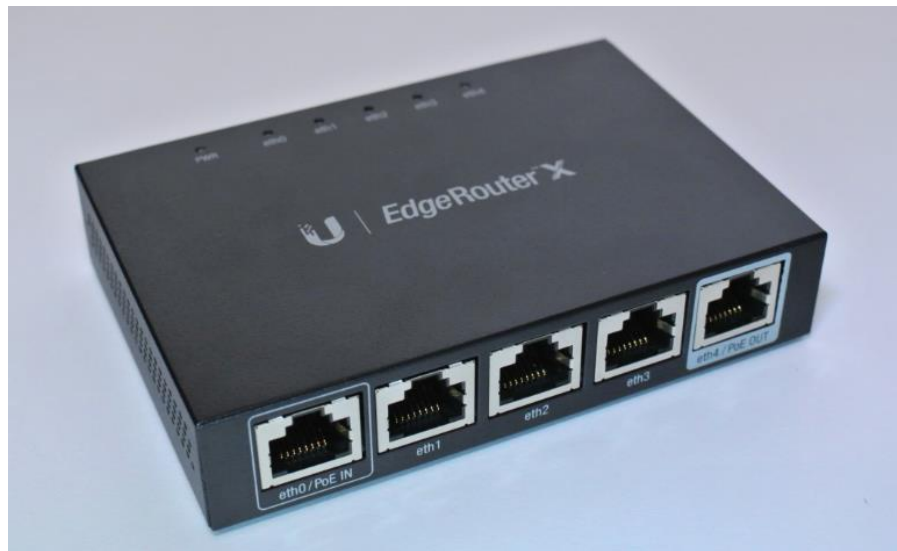
Рисунок 2.14 – Маршрутизатор Ubiquiti EdgeRouter X [20]
