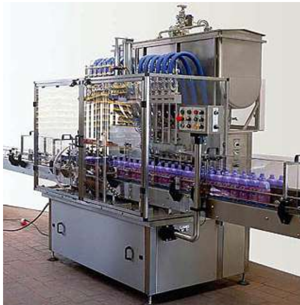
Рисунок 1.3 – Фото автоматичної лінії рядного типу
