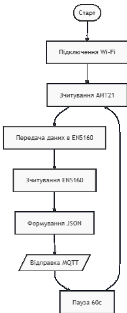
Рисунок 2.11 – Блок-схема алгоритму роботи мікропрограмного забезпечення та взаємодії з хмарним сервером
