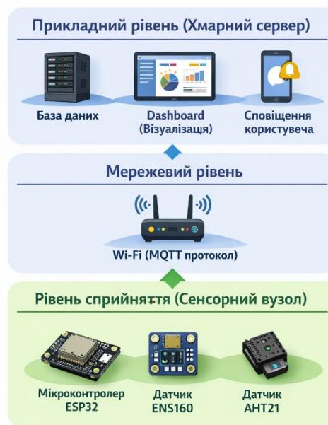
Рисунок 1.10 – Трирівнева архітектура IoT-системи моніторингу
