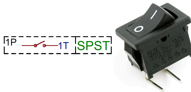
Рис. 5 - Однополюсний вимикач (SPST): конструкція та схема комутації.
