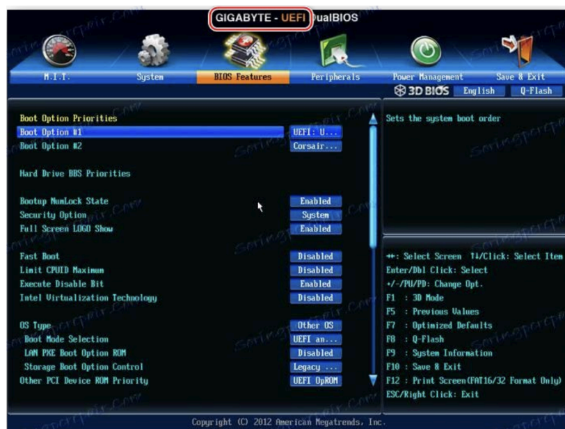
Рис. 3 - Приклад UEFI-інтерфейсу BIOS (AMI)
