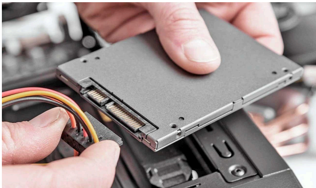
Рис. 1 - Твердотільний накопичувач SSD форм-фактора 2.5"
