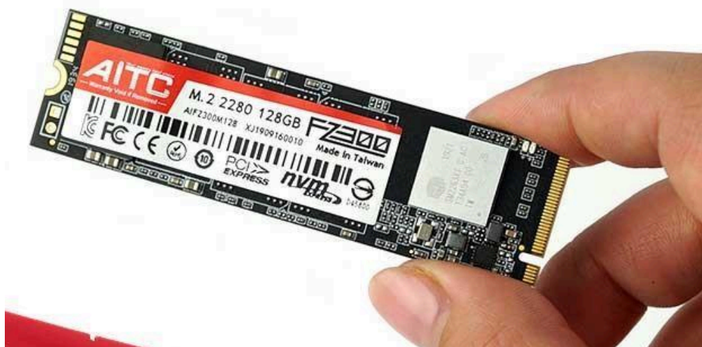
Рис. 2 - Твердотільний накопичувач SSD форм-фактора M.2
