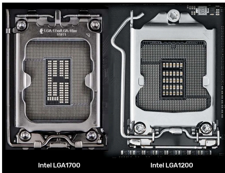
Рис. 2 - Порівняння сокетів процесорів Intel: LGA1200 та LGA1700
