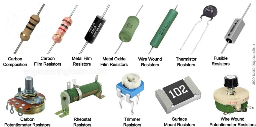
Рис. 11 - Зовнішній вигляд основних типів резисторів.
