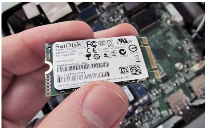
Рис. 5 – Твердотільний накопичувач форм-фактора mSATA
