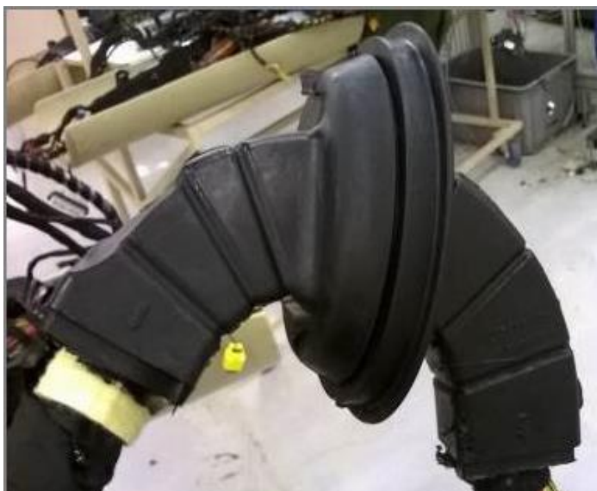
Рисунок 1.3 – Вилитий елемент захисту бортових мереж
