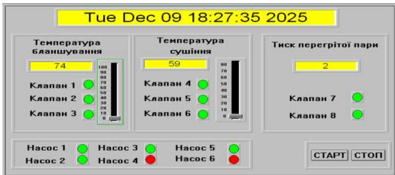
Рисунок 7.4 – Віртуальна панель керування оператора
