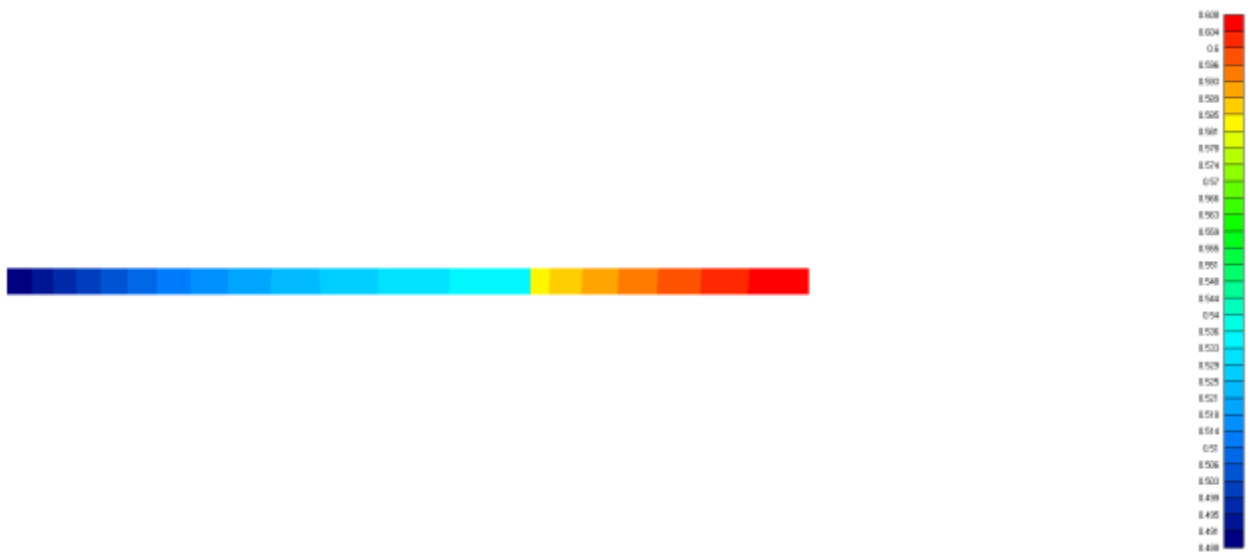
Рисунок 3.5 – Моделювання розподілу пористості для поетапного ущільнення двошарового фільтруючого матеріалу
