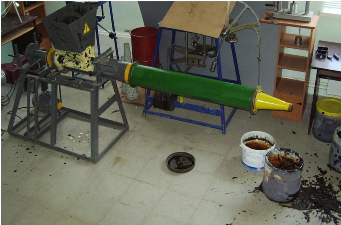
Рисунок 3.3 Загальний вигляд дослідної установки для визначення тиску на виході горизонтального шнека
