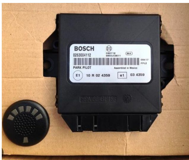
Рисунок 1.5 – Park Pilot (давач паркування) та Rear Assist (задній давач паркування) [7]
