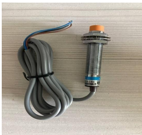
Рисунок 3.5 – Індуктивний давач LJ12A3-4-Z/BX NPN NO (нормально відкритий) [3]
