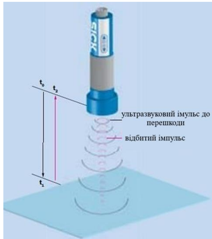
Рисунок 1.6 – Принцип роботи ультразвукового давача
