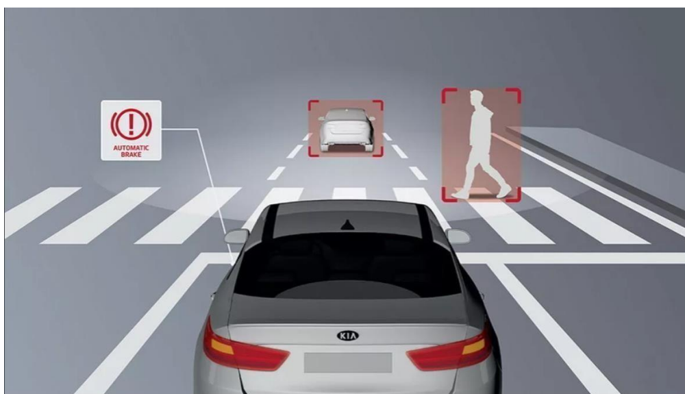
Рисунок 2.8 – Автоматичне гальмування та попереджувальний сигнал на панелі
