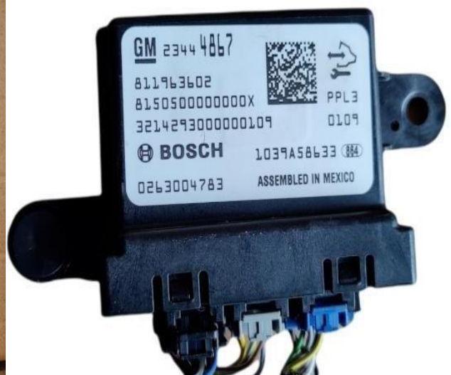
Рисунок 1.5 – Park Pilot (давач паркування) та Rear Assist (задній давач паркування) [7]
