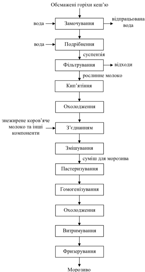
Рисунок 8.6 – Схема способу виготовлення морозива із знежиреного коров'ячого молока та «молока з горіхів кеш'ю» (Yahaya et al., 2022)
