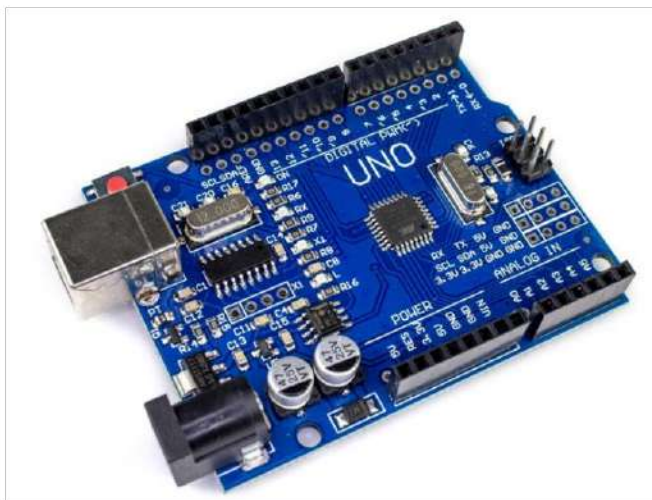
Рисунок 2.1 – Мікроконтролер Arduino Uno [22]
