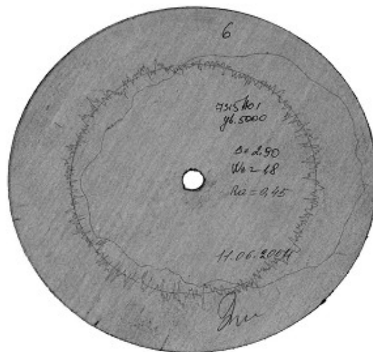
Рисунок 4.3 – Діаграма круглості підшипникової шийки шпинделя після тонкого шліфування
