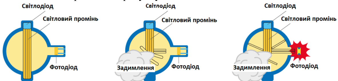
Рисунок 1 – Принцип роботи точкового давача диму
