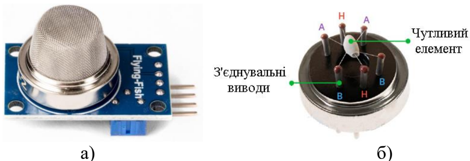
Рисунок 2 – Давач газу MQ-2 (а) та чутливий елемент з виводами (б)
