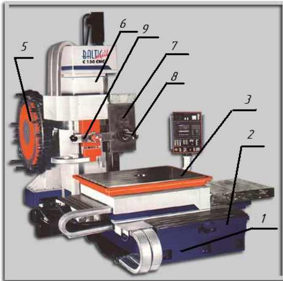
Рисунок 1.2 – Компонівка багатоцільового свердлильно-фрезерно-розточувального верстата моделі ЛР543МФ4 1 – станина; 2 – салазки; 3 – стіл; 4 – інструментальний магазин; 5 – стійка; 6 – шпиндельна бабка; 7 – шпиндель; 8 – пристрій зміни інструменту
