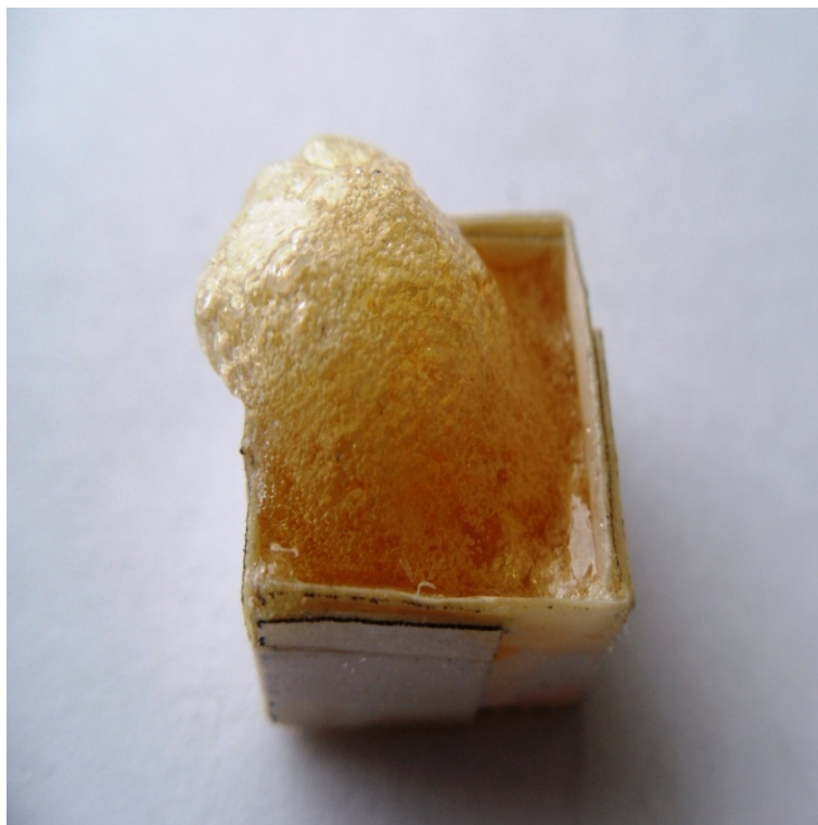
Рисунок 3.1 – Загальний вигляд зразка епоксиполімеру, структурованого шляхом нагрівання до температури 373 К без попередньої витримки за кімнатної температури
