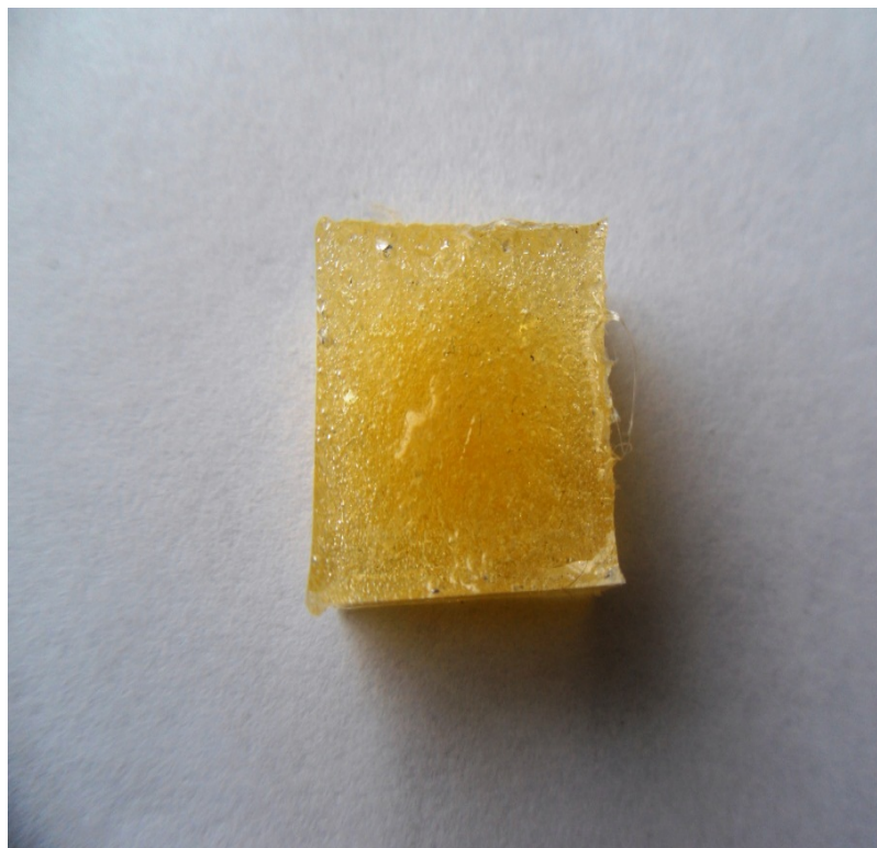
Рисунок 3.2 – Загальний вигляд зразка епоксиполімеру, структурованого шляхом нагрівання до температури 373 К після попередньої витримки за кімнатної температури протягом 2
