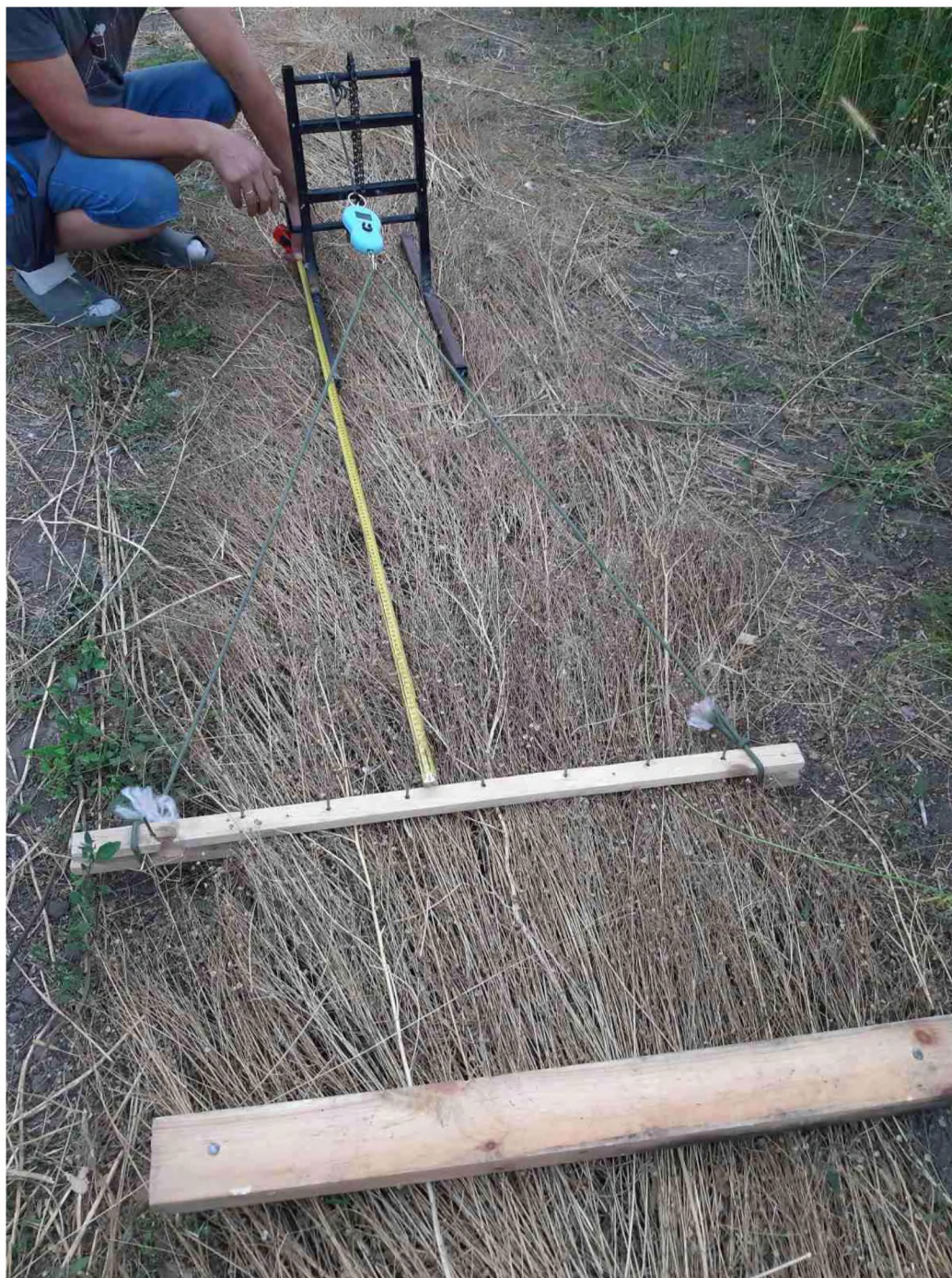
Рисунок 3.9 – Проведення досліджень з розтягу валків льону –довгунця сорту Міандр
