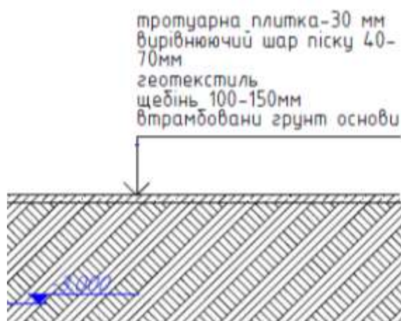
Рисунок 3.3. Конструкція покриття доріжок
