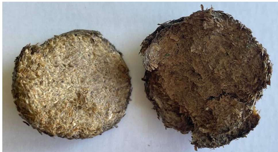
Рис. 3.5. Загальний вигляд поверхні руйнування біокомпозитів, сформованими за режимами № 1(а), № 2 (б), № 4 (в), після визначення стискання
