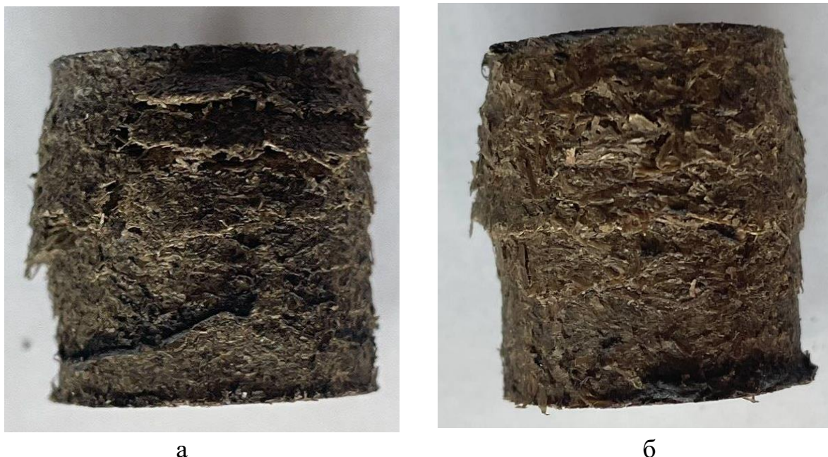
Рис. 3.2. Вигляд біокомпозитних зразків, наповнених подрібненими стеблами зернових культур в кількості 140 мас. ч. фракцією 0,5 мм (а) та 150 мас. ч. фракцією 0,7 мм (б) після стискання
