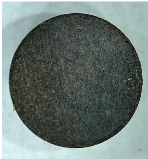
Рисунок 3.21. Загальний вигляд поверхні біокомпозитів із ступенем підсушування композиції 20% з вмістом наповнювача в кількості: а – 140 мас. ч.; б – 150 мас. ч.; в – 160 мас. ч.; г – 170 мас. ч.; д – 180 мас. ч.
