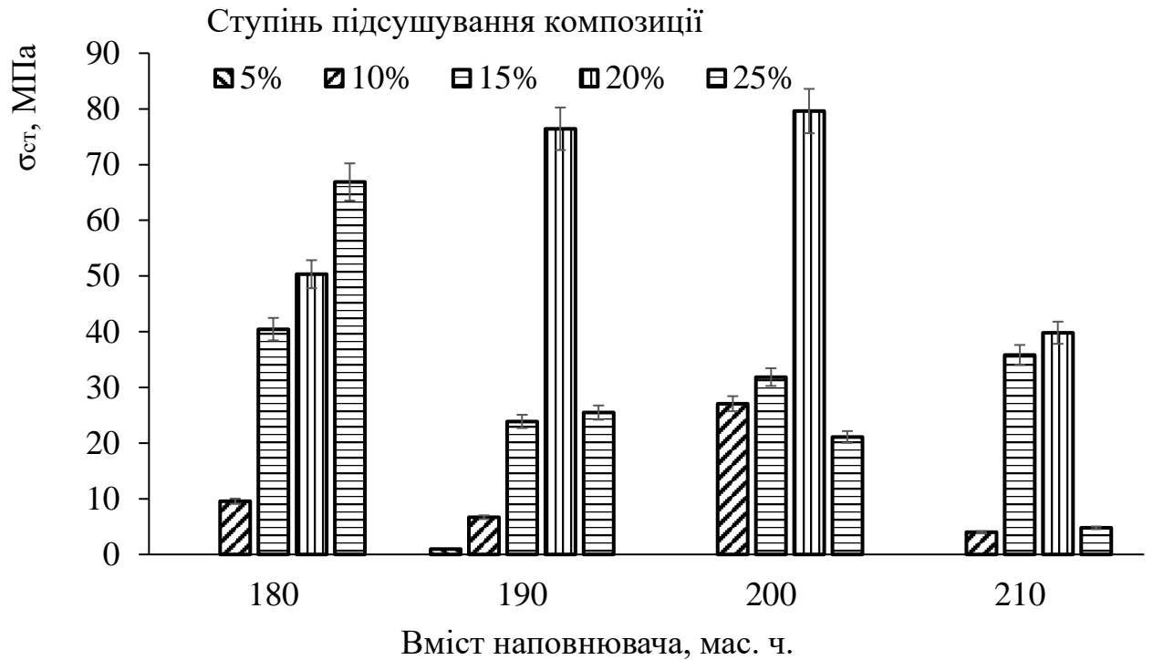
Рис. 4.1. Міцність на стискання біокомпозитів, наповнених кавовою гущею, залежно від вмісту наповнювача та ступеня підсушування композиції
