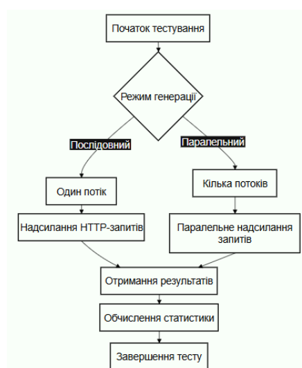
Рисунок 3.9 – Блок-схема генерації послідовного та паралельного навантаження
