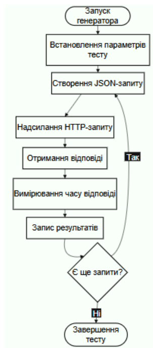
Рисунок 3.8 – Блок-схема роботи генератора навантаження
