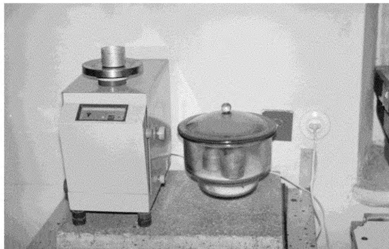
Рисунок 3.3 - Прилади і обладнання для визначення вологості вороху льону
