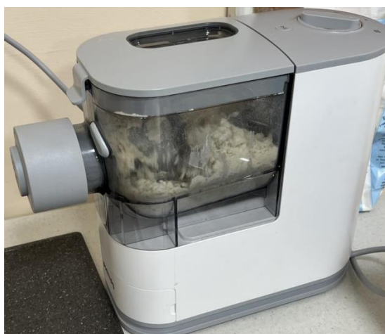
Рисунок 3.1 – Процес замішування тіста у макаронному пресі
