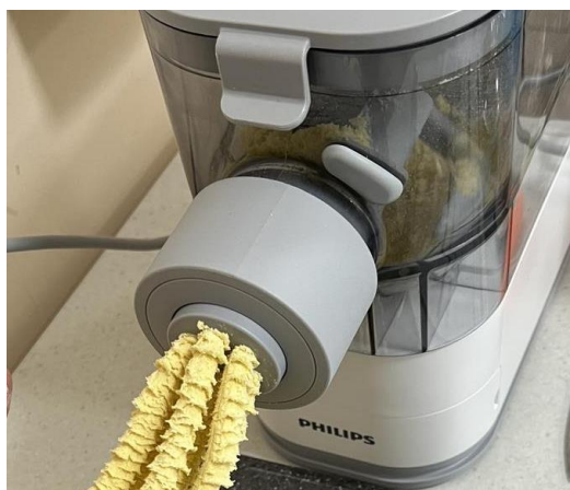
Рисунок 3.2 – Процес формування макаронних виробів з яєчними продуктами
