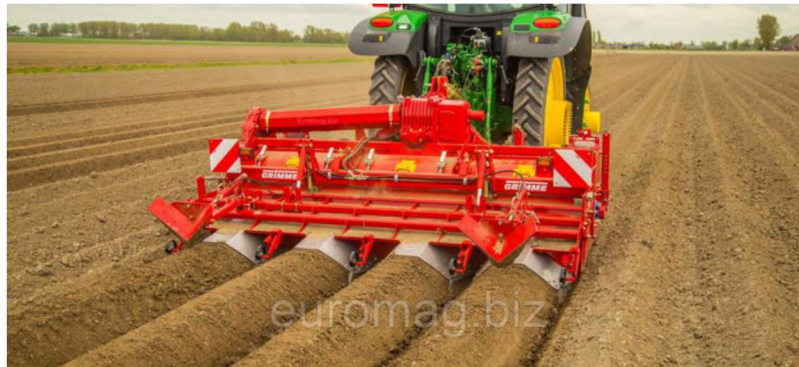
Рисунок 2.5. – Машина для нарізання гребенів Grimme GF 400
