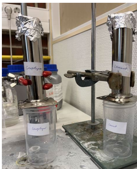
Рисунок 2.15 – Установка для випробування на протікання
