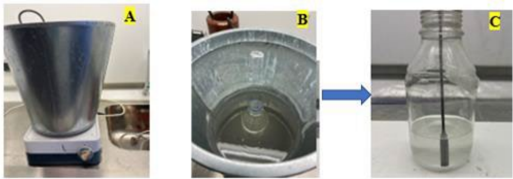
Рисунок 2.17 – А) установка водяної бані; В) рідкий метасилікат натрію, повністю занурений у гарячу воду; С) кристально прозорий 40% розчин після нагрівання
