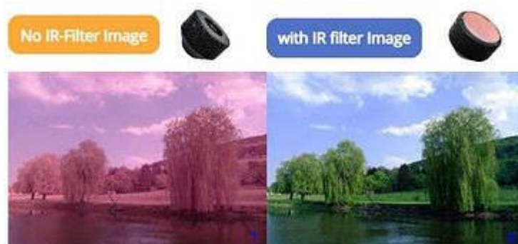
Рисунок 2.15 – Пояснення до впливу ІЧ фільтра на створення зображення
