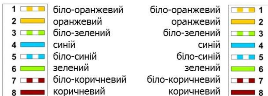
Рисунок 5.9 – Схема розмінування 8-ми жильного кабелю для прямого з'єднання комп'ютера з пристроєм комутації
