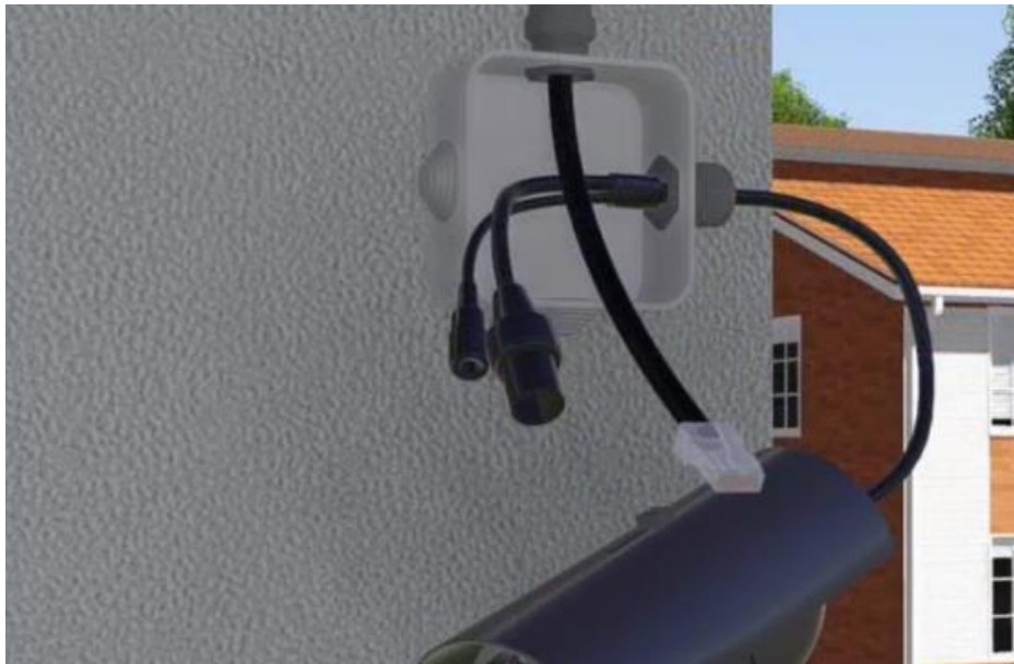
Рисунок 6.21 – Приклад введення у розподільчу коробку кабелів від IP-камери і кабель з шафи
