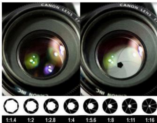
Рисунок 2.2 – Розкриття діафрагми за відповідних значень відносних отворів
