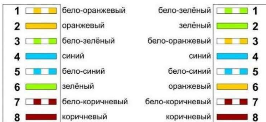
Рисунок 5.10 – Схема розмінування 8-ми жильного кабелю для перехресного з'єднання
