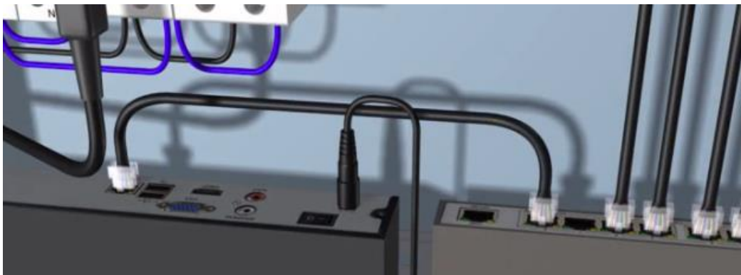
Рисунок 6.22 – Приклад розведення проводів в шафі до PoE комутатора та з'єднання відеореєстратора з комутатором
