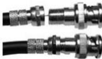
Рисунок 5.7 – Приклад використання роз'єму F типу та перехідника F-BNC
