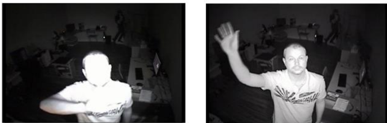
Рисунок 4.1 – Кадр без адаптивного підсвічування (фото зліва) та з адаптивним підсвічуванням (фото справа)
