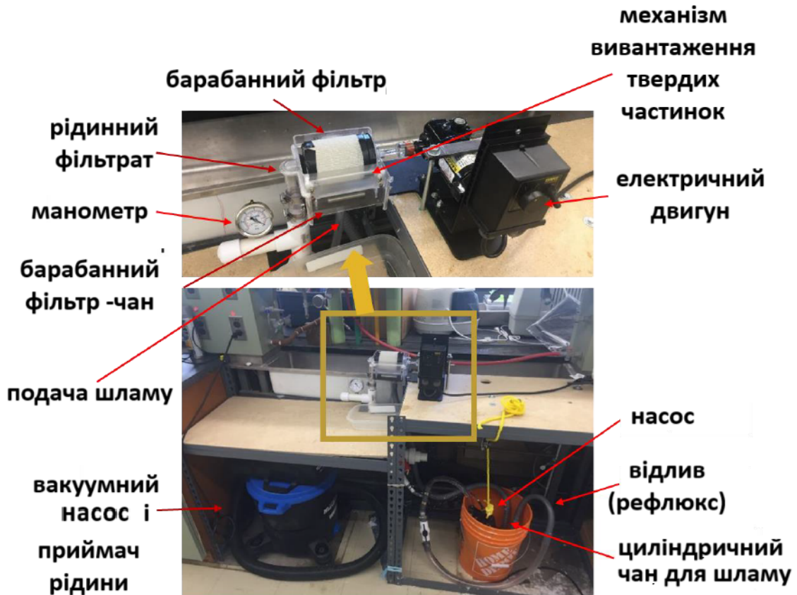
Рисунок 2.5 – Система фільтрації лабораторного масштабу
