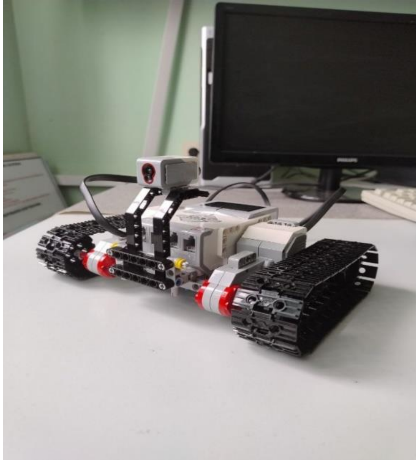
Рисунок 2.1 – Загальний вигляд роботизованої платформи LEGO Mindstorms EV3
