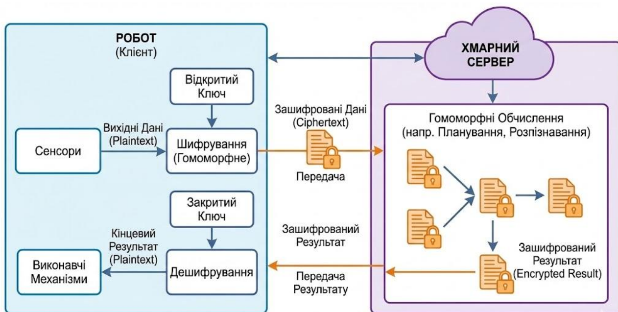
Рисунок 1.4 – Схема обробки даних із використанням гомоморфного шифрування у хмарній робототехніці [10]
