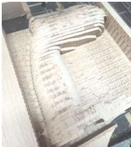
Рисунок 4.6 – Результат чорнового оброблення
