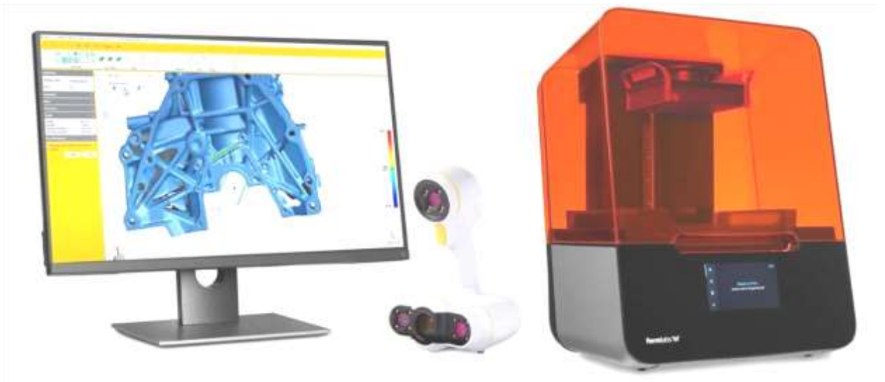
Рисунок 1.11 – Настільні SLA 3D-принтери ідеально підходять для перетворення реверсивно-інжинірингових конструкцій на фізичні деталі.
