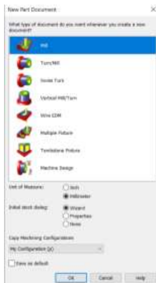
Рисунок 3.4 – Вибір виду обробки та одиниць вимірювання
