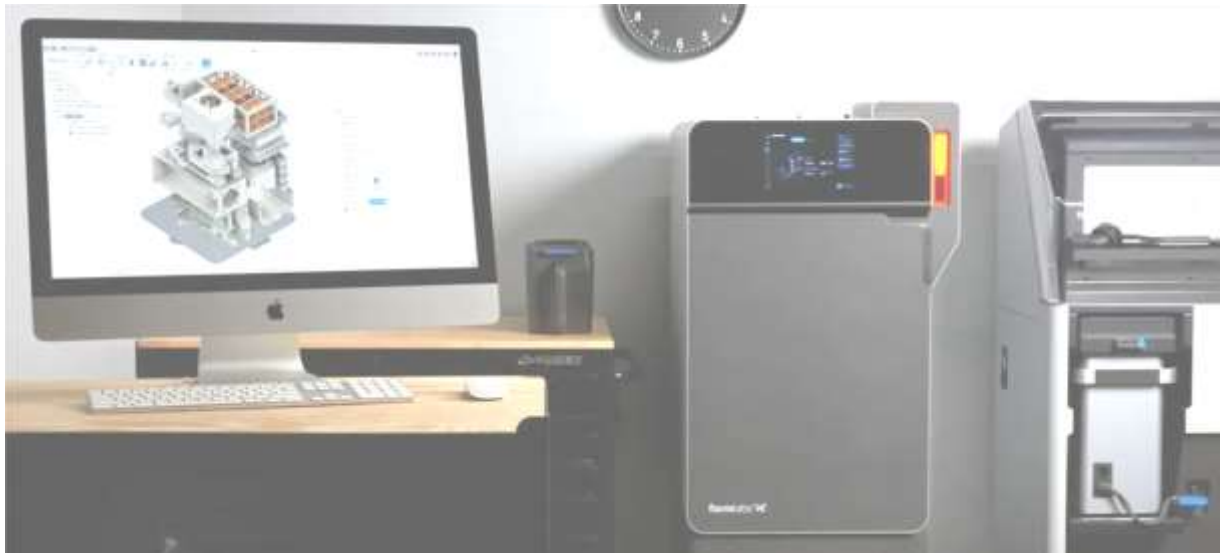
Рисунок 1.12 – 3D-принтери SLS ідеально підходять для реверсивного інжинірингу складних геометрій.
