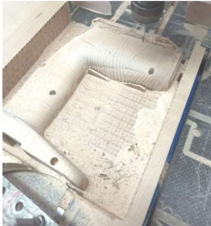
Рисунок 4.7 – Фрагмент роботи чистового оброблення
