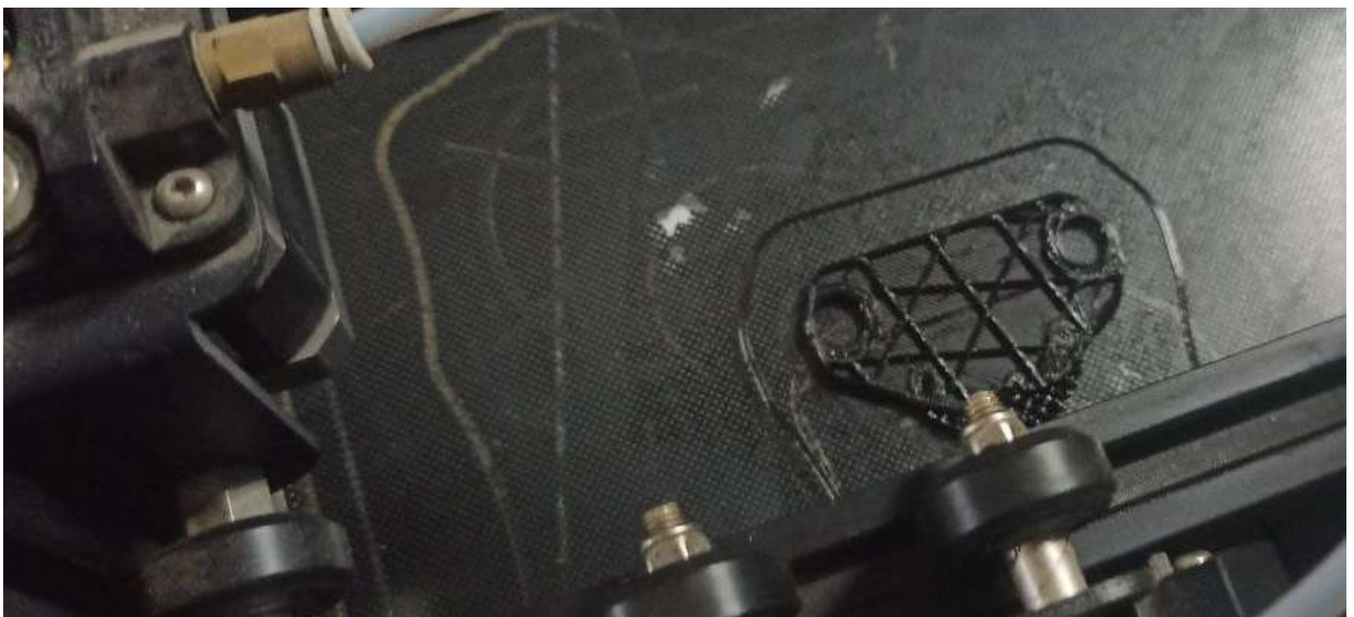
Рисунок 4.3 – Тип заповнення об'єму деталі.
