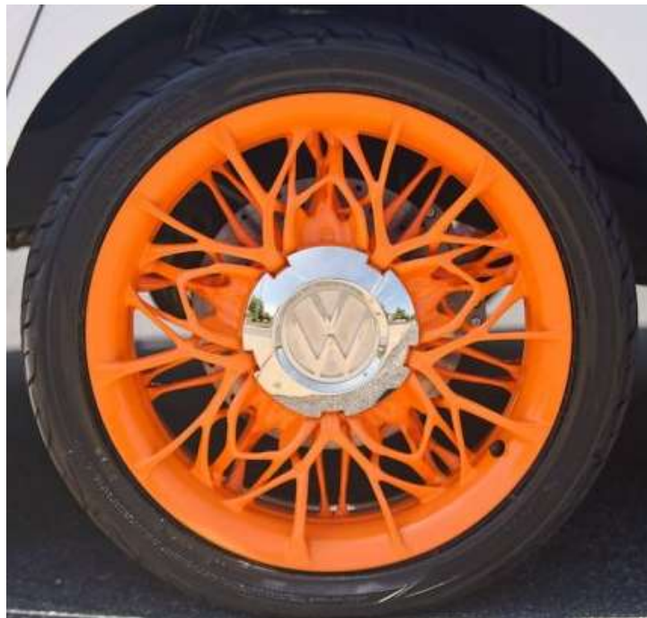
Рисунок 1.7 – Колесо автомобіля спроектоване генеративним моделюванням.
