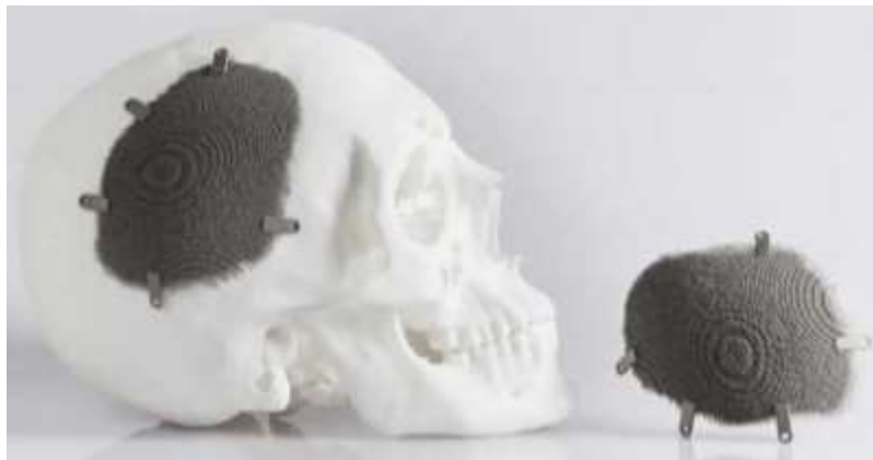
Рисунок 1.5 – Черепний імплантат, виготовлений за допомогою металоаддитивного виробництва.
