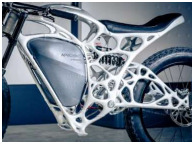
Рисунок 1.4 – Легка рама мотоцикла з оптимізованою топологією, виготовлена за допомогою 3D-друку металом.
