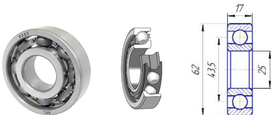
Рисунок 2.1 – Підшипник кульковий радіальний однорядний серії 305
