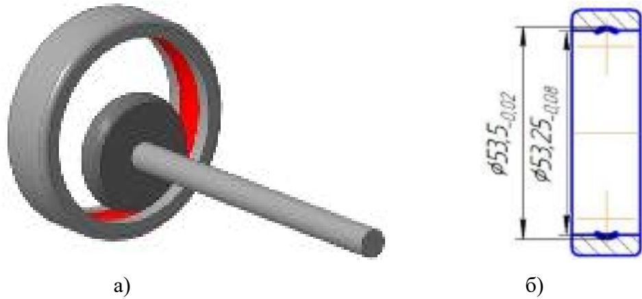
Рисунок 2.4 – а) Схема шліфування доріжки кочення, б) технологічні налагодження шліфування
