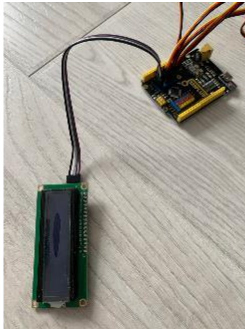
Рисунок 3.4 – З'єднання плати керування з LCD дисплеєм
