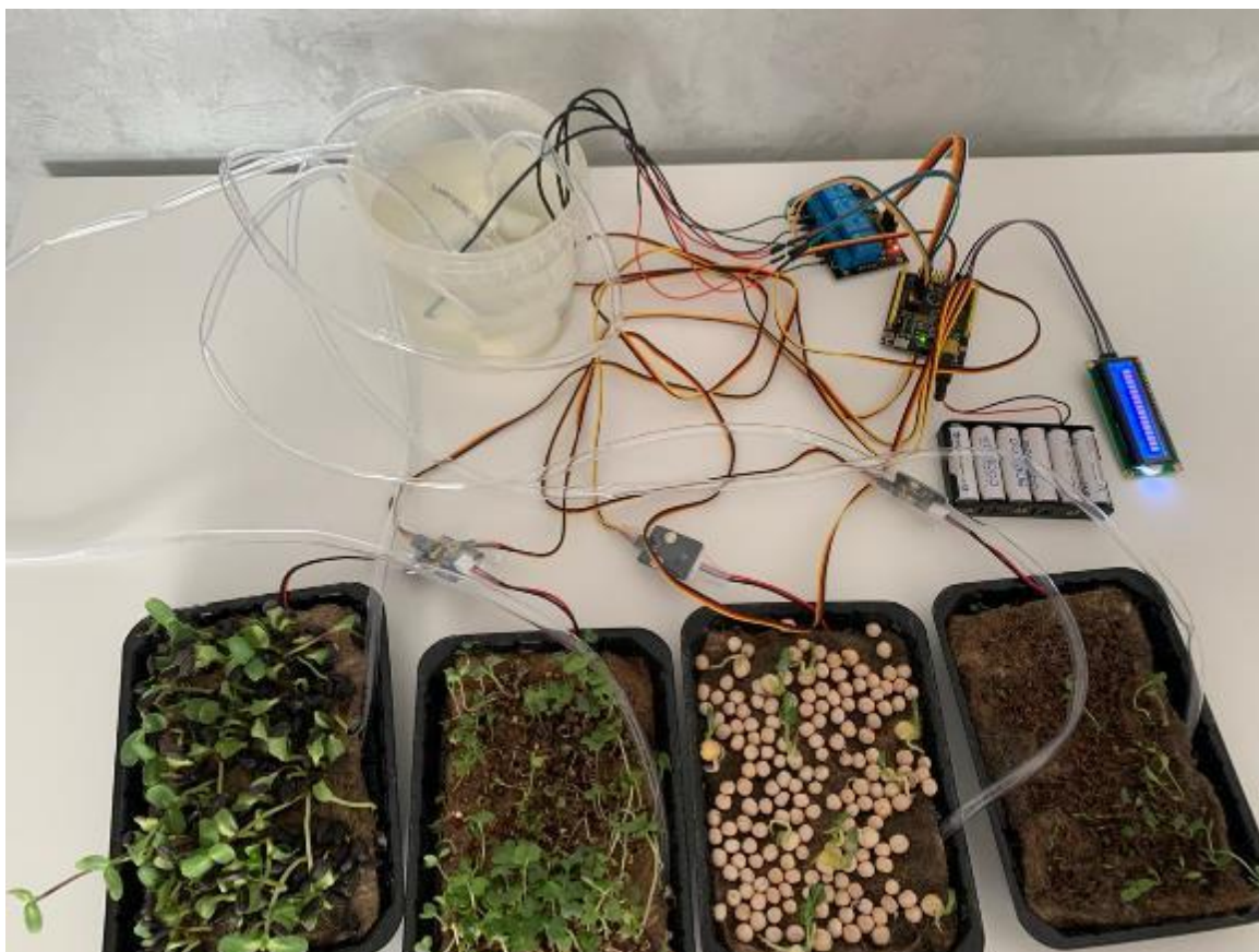
Рисунок 3.15 – Система поливу мікрогрін в домашніх умовах
