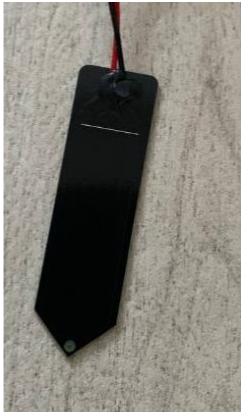
Рисунок 2.2 – Ємнісний датчик вологості ґрунту SVG
