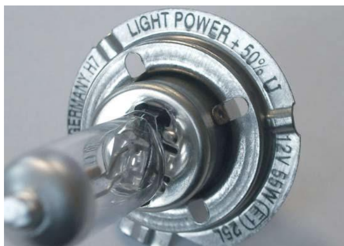
Рисунок 1.5 – Маркування галогенових автомобільних ламп
