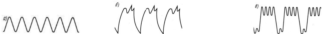
Рисунок 2.10 – Форма кривої випрямленої напруги генератора: а — генератор справний; б — вентиль пробитий; в — обрив в колі вентиля (обмотці статора).
