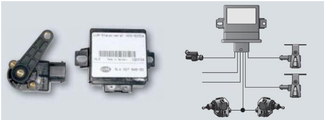
Рисунок 1.14 – Датчик та блок керування коректора LWR
