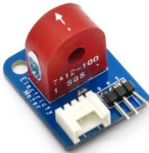
Рисунок 10.1 – Датчик змінного струму 5А на TA12-100 для Arduino
