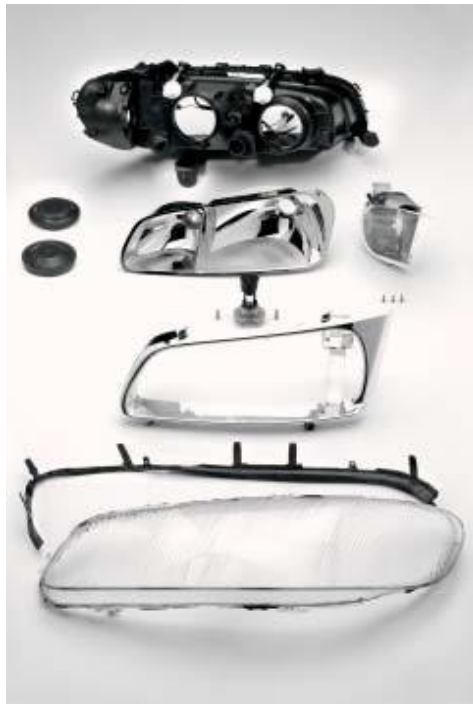
Рисунок 1.6 – Складові деталі автомобільних фар
