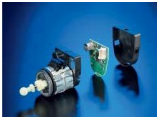
Рисунок 1.16 – Зовнішній вигляд інтелектуального крокового двигуна
