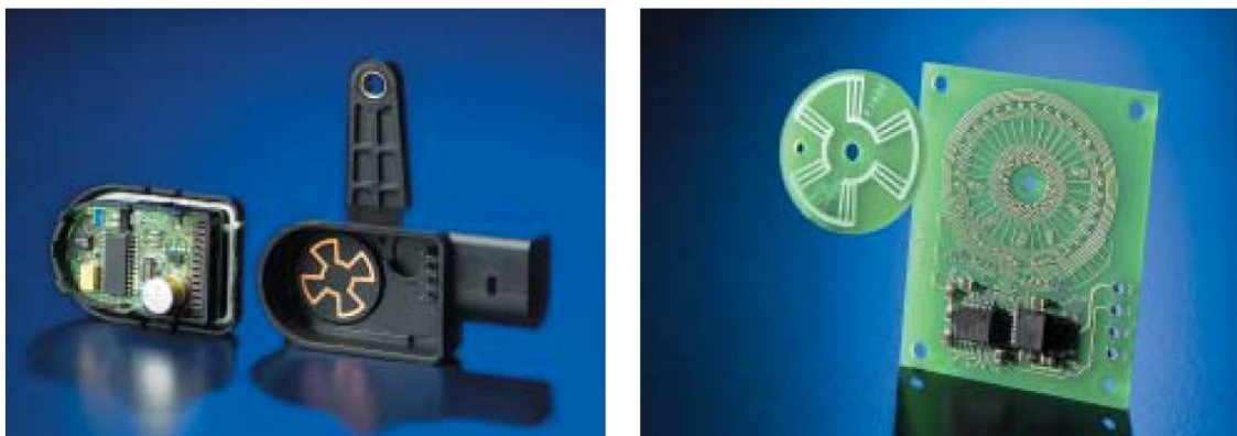
Рисунок 1.17 – Блок управління коректора фар, інтегрований у датчик
