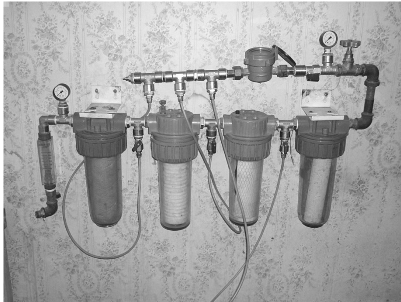
Рисунок 4.10 – Загальний вигляд установки для визначення проникливості пористого матеріалу
