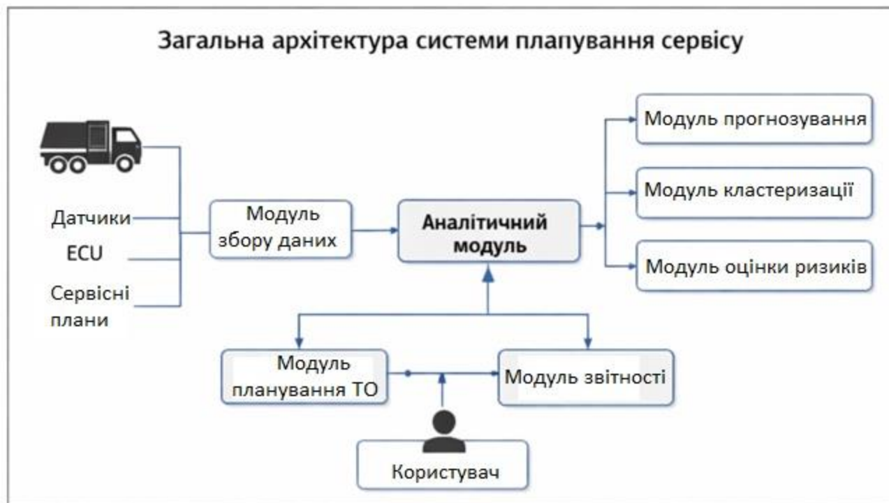
Рисунок 3.3 – Архітектура системи планування сервісного обслуговування вантажних автомобілів
