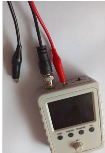
Рисунок 3.9 – Встановлення BNC роз'єму і виходу тестового сигналу
