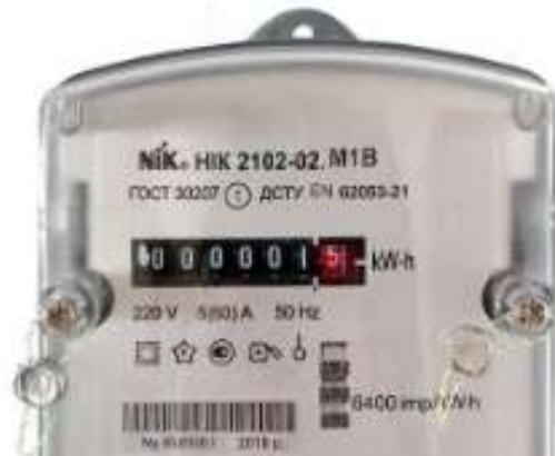
Рисунок 2.5 – Лічильник НІК 2102 з електромеханічним відліковим механізмом [9]
