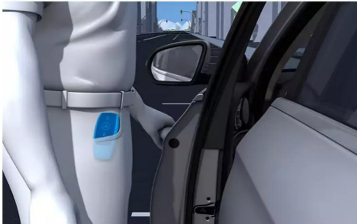
Рисунок 6.21 – Принцип дії СБДА
