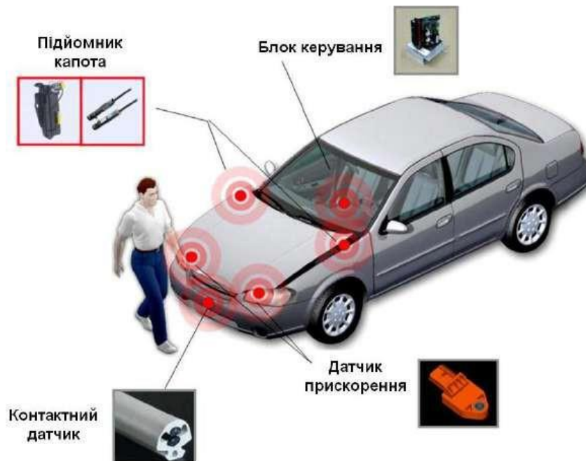
Рисунок 7.9 – Схема системи захисту пішоходів
