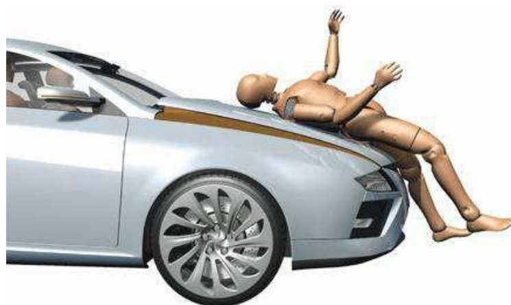
Рисунок 7.11 – Активний капот системи захисту пішоходів
