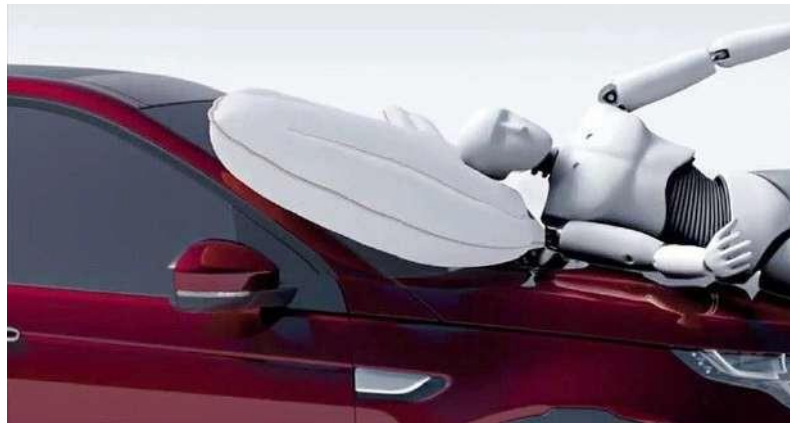
Рисунок 7.12 – Активний капот з подушкою захисту пішоходів
