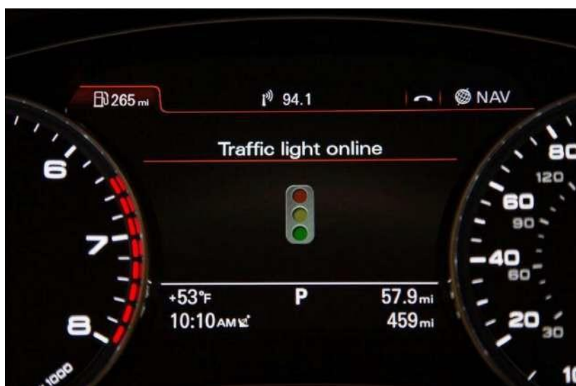
Рисунок 4.22 – Система інформування про світлофори «Audi Traffic Light Online» автомобіля Audi A6
