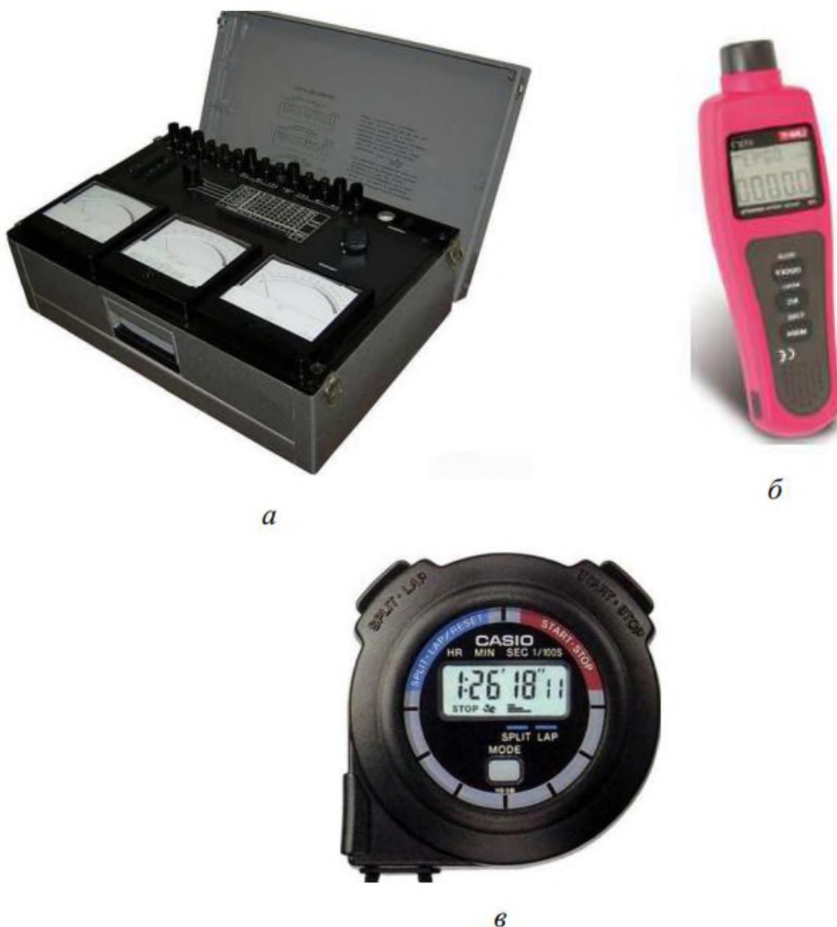
Рисунок 3.3 – Контрольно-вимірвальне обладнання експериментальної установки: а – комплект вимірвальної апаратури К-505; б – ручний тахометр, в – електронний секундомір
