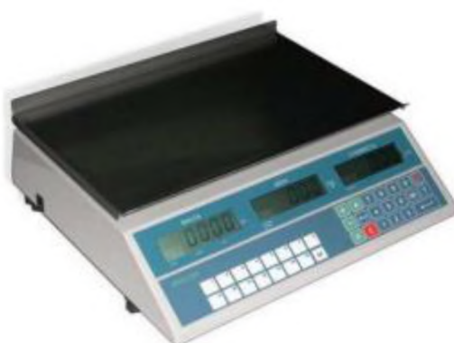
Рисунок 3.7 – Ваги електронні, що використовуються при рівномірному укладанні подрібнюваного матеріалу на транспортер, що живить
