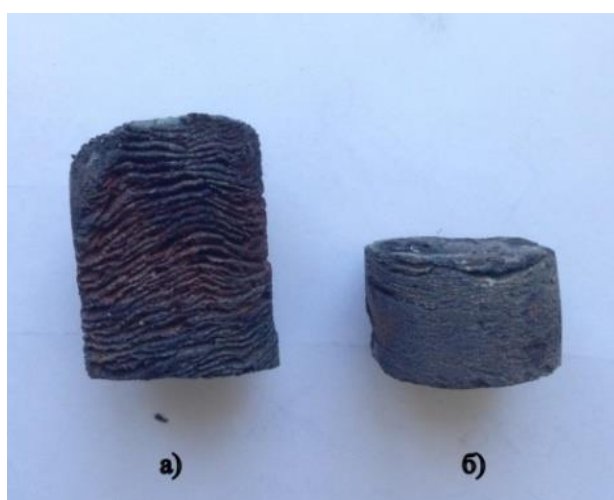
Рисунок 4.5 Загальний вигляд зразків вмісту (Ti+V) + xTi після синтезу: а) ПТМ-2, б) ПТС-2.
