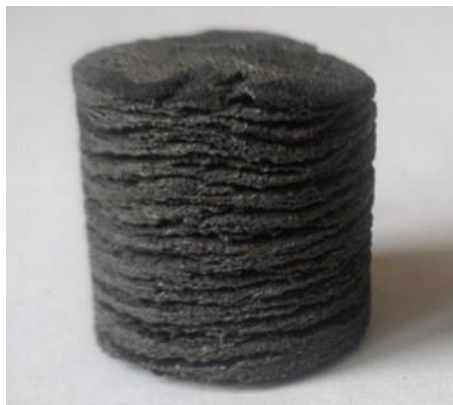
На рисунку наведені фотографії зразків після синтезу. Фотографії синтезованих зразків із шихт складу (\text{Ti}+\text{V}) + (\text{Ti}+0,5\text{C}) + x\text{Ti} , де x - надлишок титану: а) 15%; б) 30%.
