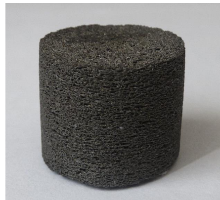
На рисунку наведені фотографії зразків після синтезу. Фотографії синтезованих зразків із шихт складу (\text{Ti}+\text{V}) + (\text{Ti}+0,5\text{C}) + x\text{Ti} , де x - надлишок титану: а) 15%; б) 30%.
