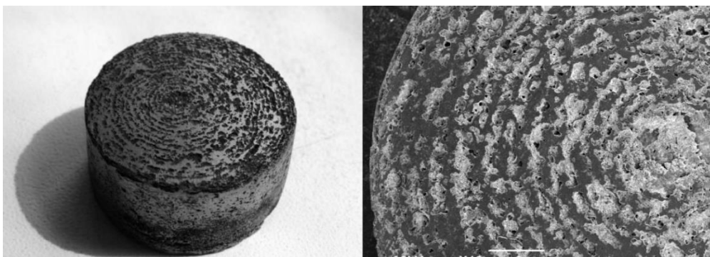
На рисунку наведені фотографії зразків після синтезу. Фотографії синтезованих зразків із шихт складу (\text{Ti}+\text{V}) + (\text{Ti}+0,5\text{C}) + x\text{Ti} , де x - надлишок титану: а) 15%; б) 30%.
