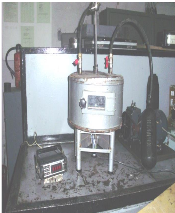
Рисунок 3.7 Загальний вигляд установки для здійснення СВС – процесу
