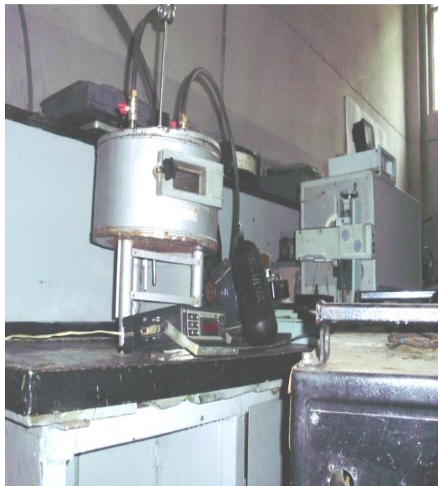
Рисунок 3.7 Загальний вигляд установки для здійснення СВС – процесу
