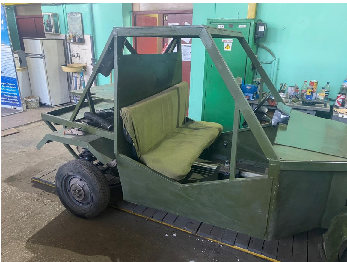
Рисунок Б9 – виготовлений багатofункціональний легковий автомобіль БАГГІ для військових потреб
